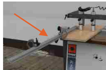
Pravítko 1,5 m délky s překlápěcími dorazy. V poloze na bočním pravítku umožňuje vrtání řady otvorů do ploch dlouhých kusů nábytkových dílců. (standardní výbava)
