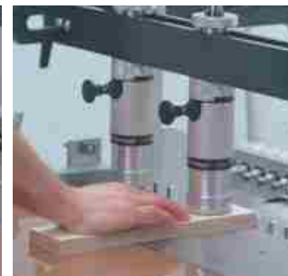
Pneumatické přítlaky s rychlým nastavením výšky obráběných kusů. Minimální vzdálenost mezi plochou přítlaku a dílcem zabraňuje úrazům
