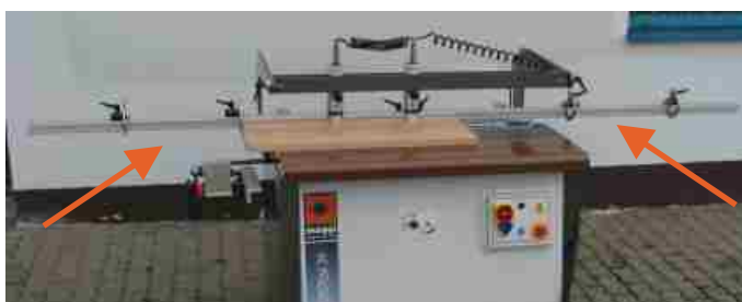
Pravítko o délce 3 m, složené ze dvou 1,5 m dlouhých pravítek (pravé a levé) a překlápěcích dorazů. V této poloze s ním lze vrtat do plochy především řady otvorů v rozteči 32 mm. (standardní výbava)
