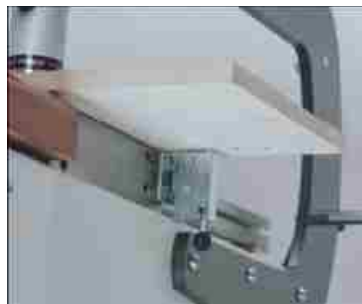
Referenční trn pro vrtání nekonečné řady otvorů do plochy v rozteči 32mm (Příslušenství za příplatek)
