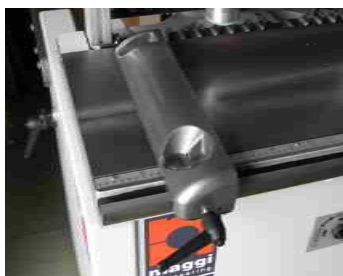
BORING 21 PRESTIGE: Masivní litinová boční pravítka s odměřováním a lupou. (standardní výbava)
